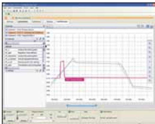
Функция осциллографа ПО SoMove
