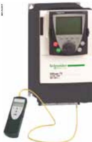
Конфигурирование ПЧ Altivar 71 с помощью мультизагрузчика
