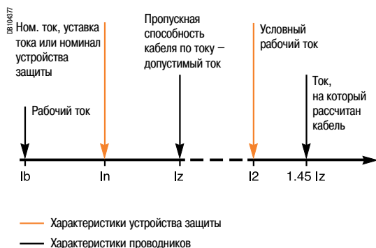
Токи в электропроводке, защищенной предохранителем
