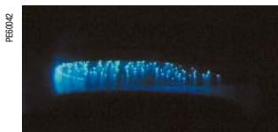
Рис. 3. Распределение дуги в вакууме в условиях аксиального магнитного поля
