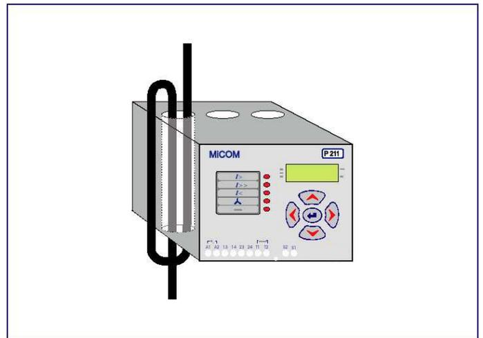
Рис. 2 Подключение MiCOM P211, когда  $I_n < I_b \max$
