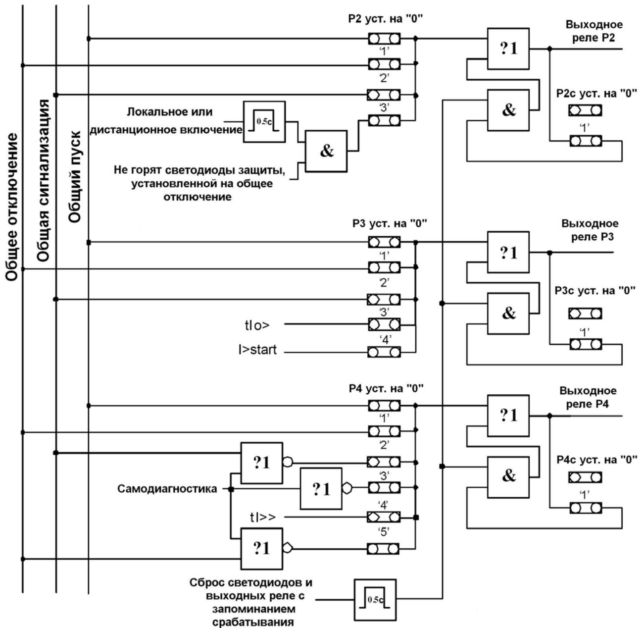
Рис. 17. Конфигурация выходных реле P2, P3, P4
