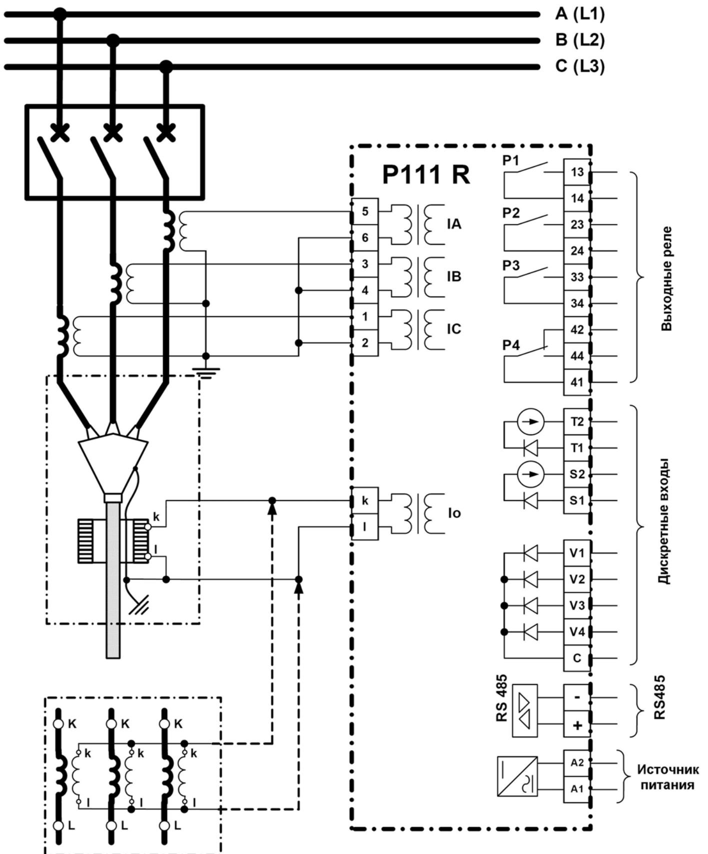
Рис. 19. Схемы подключения
