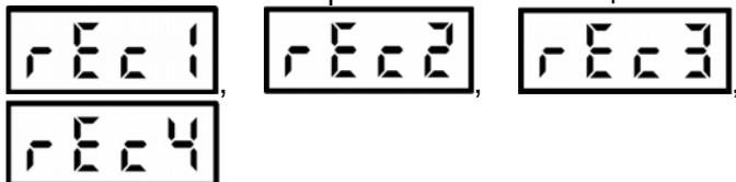
Можно сохранять записи информации о 4 последних отключениях, включая причины отключений, а также значения фазных токов и токов нулевой последовательности в момент отключения замыкания.
