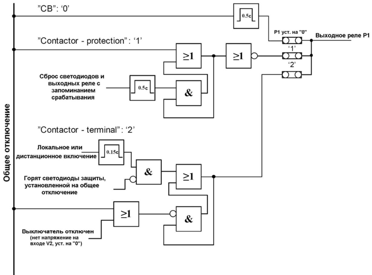
Рис. 16. Конфигурация выходного реле P1
