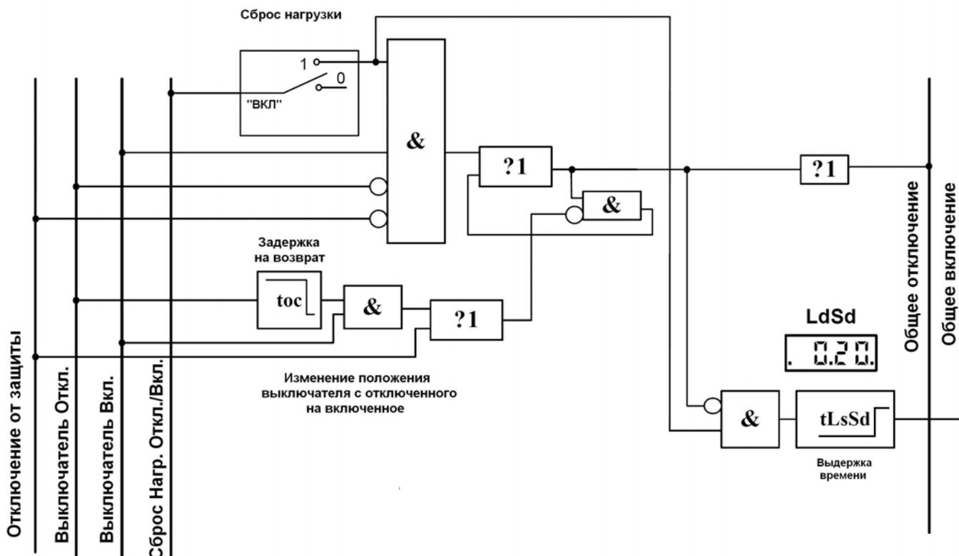
Рис. 11. Логическая схема отключения/включения от сброса нагрузки
