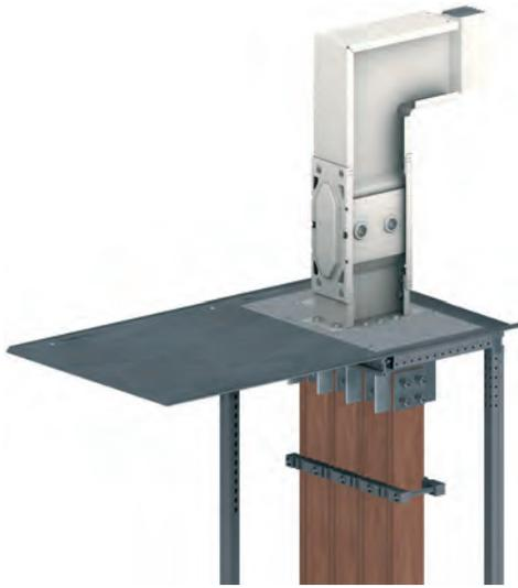
Canalis KT может подключаться к щитам с помощью универсального вводного блока. Для упрощения подключения, рекомендуется выполнить ошиновку внутри щита с **межцентровым расстоянием шин 115 мм**.
