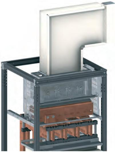
В щитах может быть установлен блок подключения для Canalis KT. Подключение к щиту производится стандартным элементом шинпровода (прямая секция, угол и т.д.) и соединительным устройством (аналогичным тем, которые используются для соединения элементов шинпровода). Шинпровод вводится в щит сверху через крышу.
