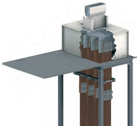
Подключение может осуществляться гибкими шинами, изолированными или нет, и просверленными с одного конца или с двух. Они поставляются с болтами, шайбами и гайками с двойной головкой для присоединения к прямым или угловым вводным блокам.
