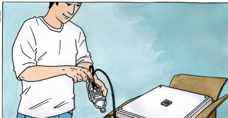
Установите светильник на подвесной потолок и подключите отводной блок к шинопроводу Canalis KDP.
