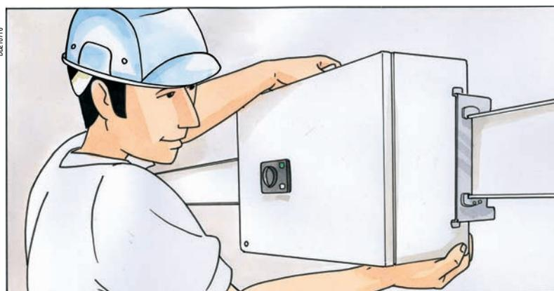
Подключите автоматический выключатель внутри отводного блока.
