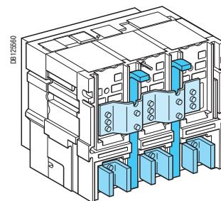
С короткозамыкающей перемычкой на нижних соединениях
