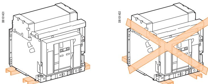
Установка на поперечных металлоконструкциях
