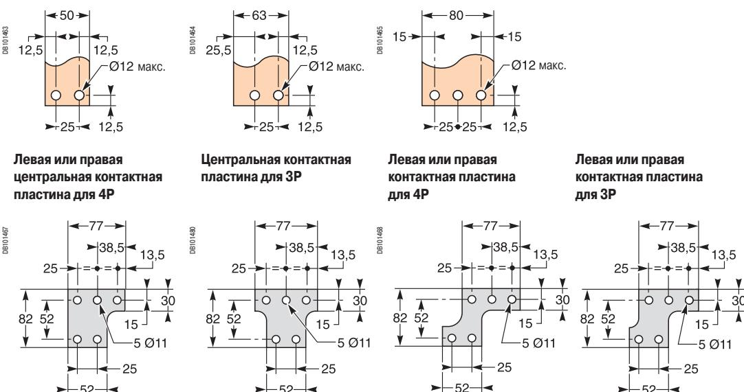
**Заднее присоединение, вертикальные контактные пластины**
