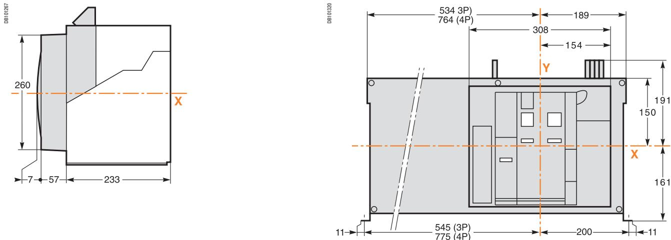
**Крепление на плате или на металлоконструкции**
