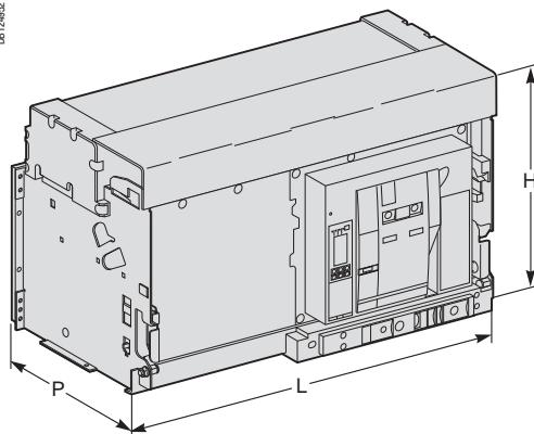
Masterpact NW40b с повышенной защитой от коррозии
