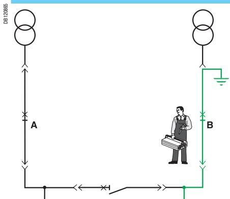
При выполнении работ на секции **B** сети шиносоединительный выключатель обычно отключен. Чтобы защитить персонал в случае непреднамеренного включения этого аппарата, вместо автоматического выключателя **B** установлен короткозамыкатель-заземлитель, входные клеммы которого соединены с землёй. Таким образом, секция **B** сети имеет потенциал Земли, что обеспечивает полную безопасность работающего персонала.
