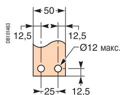
**Переднее вертикальное присоединение с пластинами-переходниками**
