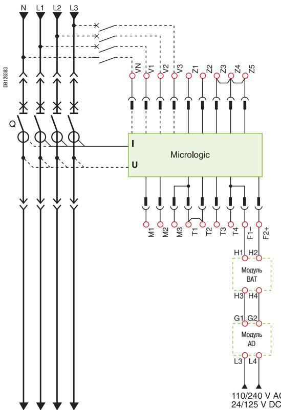
■ Внешний источник питания 24 В пост. тока (модуль AD) блока контроля и управления Micrologic (F1-, F2+) не требуется для базовых защит LSIG.
