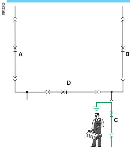
При выполнении работ на отходящей линии **C**, короткозамыкатель-заземлитель (установленный вместо автоматического выключателя **C**), входные клеммы которого соединены с землёй, обеспечивает полную безопасность, даже если все остальные аппараты электроустановки включены.
