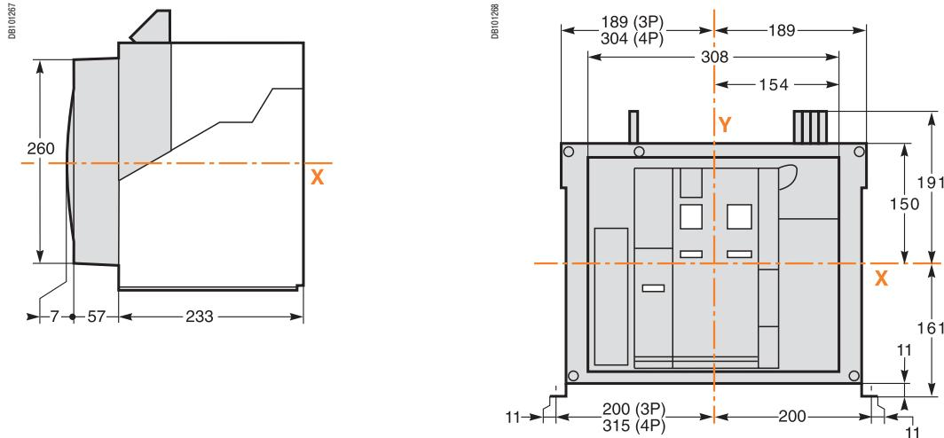
**Крепление на плате или на металлоконструкции**
