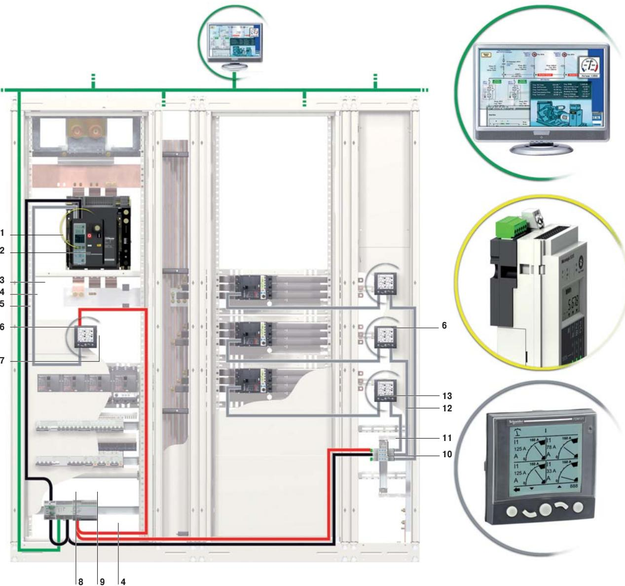
1 BCM ULP: модуль связи автоматического выключателя с портом ULP
