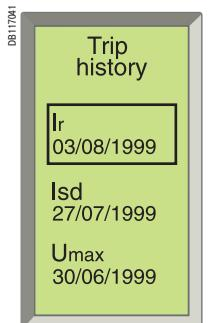
Индикация хронологического протокола отключений
