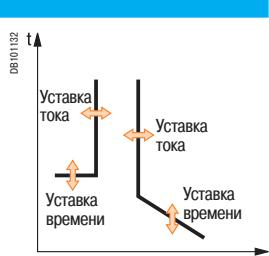
**Примечание:** правильное функционирование микропроцессорных защит, принцип действия которых основан на измерении токов, не требует какого-либо оперативного тока и обеспечивается протеканием самого первичного тока. Это справедливо при любых аварийных режимах, когда требуется срабатывание данных защит.
