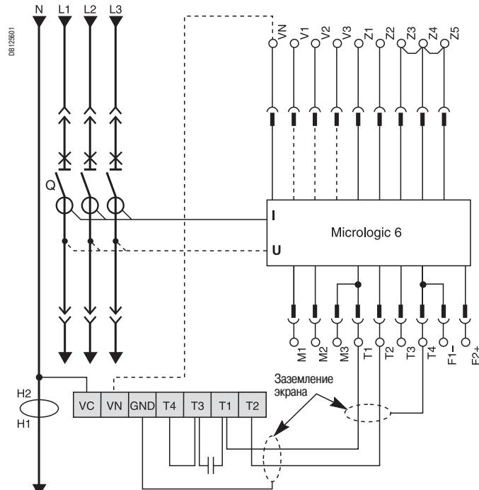
**Внешний трансформатор для защиты от замыканий на землю типа «Возврат тока через заземлитель» (SGR)**
