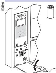
Запасной элемент питания светодиодов-индикаторов типа повреждения (1 шт.)
