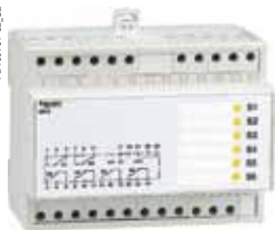
Реле, расположенное вне выключателя, с 6 независимыми переключающими контактами, управляемыми от выключателя через 3-проводное соединение (максимальная длина 10 метров)
