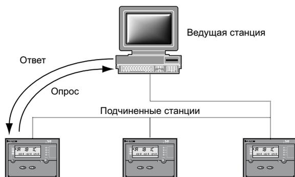
Ведущая станция может также обратиться ко всем подчиненным станциям, используя стандартный адрес 0. Такой механизм называется *широковещательной рассылкой*. Подчиненные станции не отвечают на широковещательные сообщения. С помощью этого механизма можно отправлять только те сообщения, которые не требуют от подчиненных станций обратной отправки данных.
