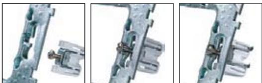
Отдельно поставляются **монтажные лапки** для фиксации изделий в монтажных коробках. Острые концы лапок заключены в безопасный пластиковый чехол и устанавливаются вместе с ним, автоматически освобождаясь при затяжке винтов
