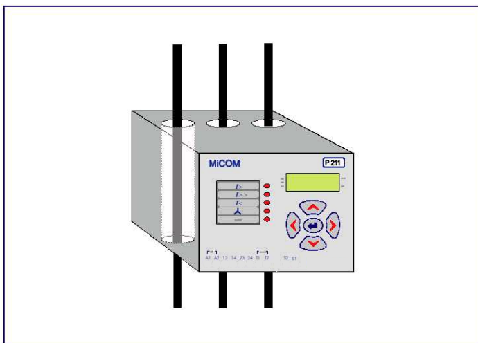
Рис. 1 Подключение MiCOM P211, когда I_{b \min} < I_n < I_{b \max}
