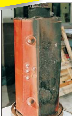
Катушка трансформатора Trihal после испытания F1
