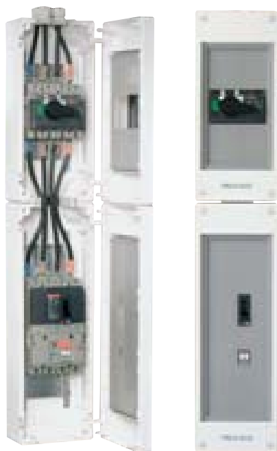
Пример установки Interpact INV + Vigicompact в 2 интерфейсных шкафах. Необходимые компоненты: интерфейсные шкафы PRA06224 и PRA06324 + комплект «Interpact» PRA90068 + комплект «Vigicompact» PRA90069 + комплект для присоединения 04149
